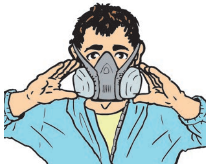
Der Sitz der Maske muss kontrolliert werden, denn sie muss perfekt abdichten.
