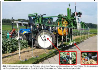
Abb. 1: Eine veränderte Version von Droplegs mit je zwei Plänen von Zungenköpfen auf zwei Höhen für die Applikation von Fungiziden und Insektiziden in Rosenkohl. Die Düsen oben am Balken werden ausgeschaltet.
